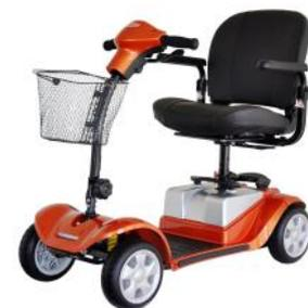
**HIGHLIGHTS:** Werkzeuglos zerlegbar, mit LED-Beleuchtung, PU-Bereifung, Vollfederung, serienmäßig mit 2 x 12 V 22 Ah Batterien, schwerstes Teil nach Zerlegung ca. 16 Kg.
