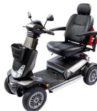
**HIGHLIGHTS:** Großes Bedienfeld und großes Display, große 200 Ampere Fahrelektronik, LED-Beleuchtung, automatische Kurvenreduzierung.
