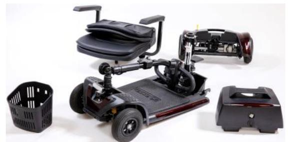
**HIGHLIGHTS:** Werkzeuglos zerlegbar, Luftbereifung, Vollfederung, schwerstes Teil nach Zerlegung ca. 20 Kg.
