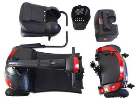
**HIGHLIGHTS:** Werkzeuglos zerlegbar, LED-Beleuchtung, Deltalenker, Vollfederung, schwerstes Teil nach Zerlegung ca. 21 Kg.
